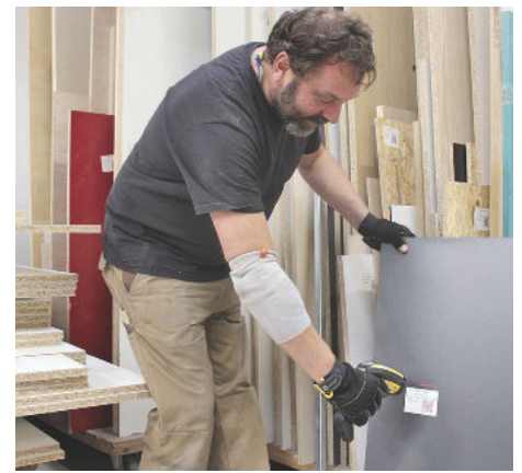
/ Am Restelager: Das Ein- und Auslagern mit Etiketten und Handschanner unterstützt die Resteverwaltung.
