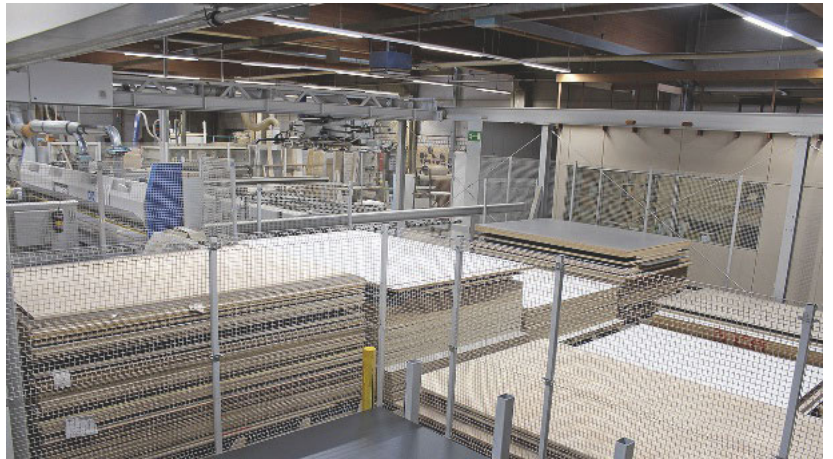
/ Die nach Maß eingepasste Zuschnittzelle bei Stöhr: Das chaotische Lagerprinzip schafft enorme Plattenvielfalt auf kompaktem Raum.
