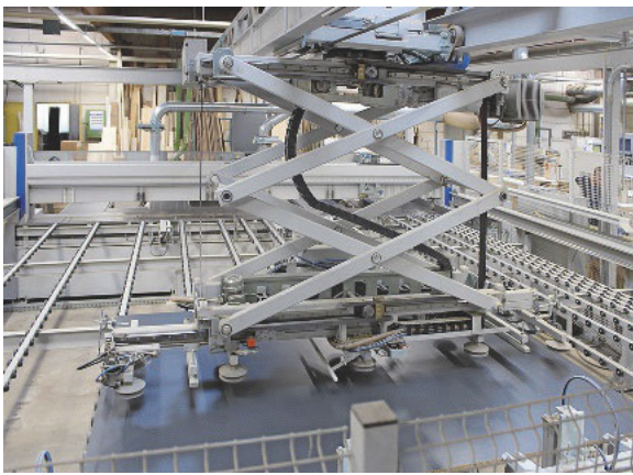
/ Automatisch auf den Säge Tisch: Die massive Portalkonstruktion und die robuste Doppelschere des Vakuumkrans sorgen für sichere Abläufe.
