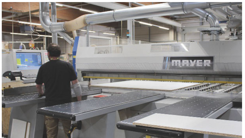
/ Das Herz der Zuschnittzelle: Die Druckbalkensäge PS 100 zeichnet sich durch grundsätzliche Bauweise und zuverlässige Schnittpräzision aus.
