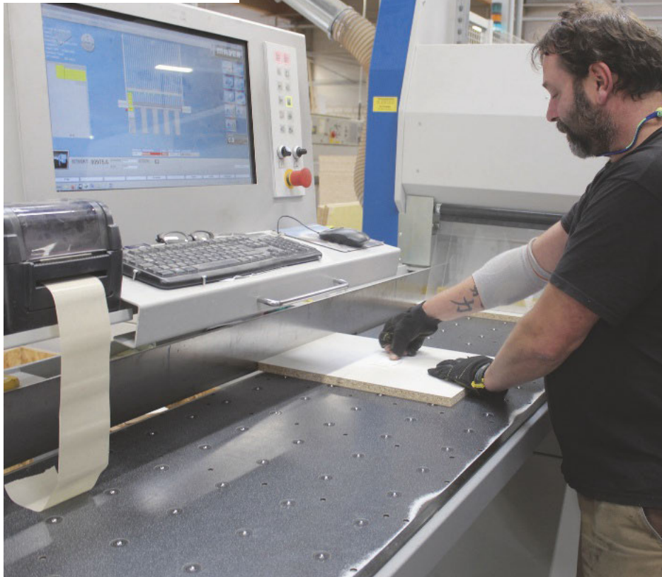
/ Etikettierung auch für Plattenreste: Am großen Touchscreen stehen dem Bediener alle relevanten Informationen übersichtlich zur Verfügung.
