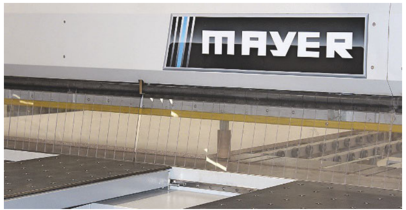
/ Bewährte Mayer-Details für beste Schnittergebnisse: Polierter Luftkissen-Maschinentisch, gesteuerter Druckbalken und die Winkelandrückvorrichtung.
