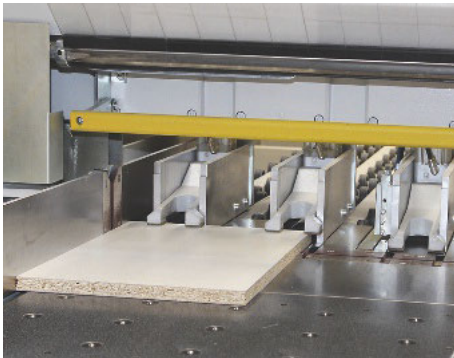
/ Spannanzgen in Doppelfinger-Ausführung sorgen für sicheres und beschädigungsfreies Klemmen der Platten.
