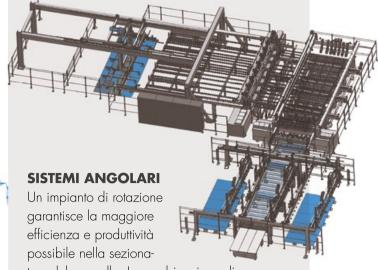
tura del pannello. La combinazione di due sezionatrici completamente automatiche in un unico impianto procura un' impressionante aumento di produzione. I Pannelli grezzi vengono inseriti su un lato ed escono fuori dall' altro lato come tagli finiti. Rotazione e trasmissione dei pezzi vengono fatte in automatico a macchina senza intervento umano. Il processo viene controllato dal nostro provato sistema di software, che lavora senza compromessi insieme con il vostro software gestionale.
